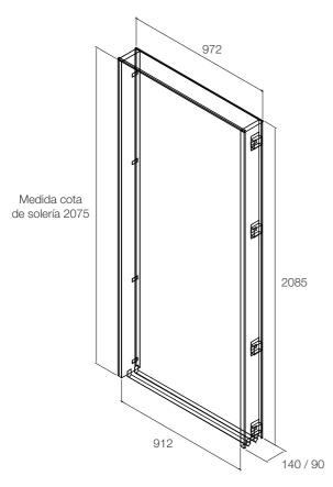
Los premarcos de las puertas de interior tendrán un grueso de muro de 140 mm.
