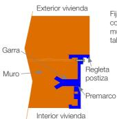
Fijar el premarco con sus correspondientes garras al hacer el muro, engrasándolo a ambos lados tal y como aparece en el dibujo.
