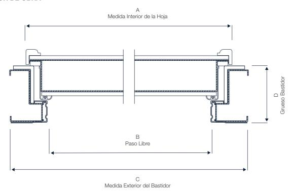
Ancho de Modificación Alto de Altura Exterior Α В С D (Bastidor) (Altura Hoja) Hoja hoja 82 cm De Serie 85 cm 78 cm 90 cm 9.8 cm 203 cm 206 cm  $\pm 7 \text{ cm}$ 72 cm Opcional 75 cm 68 cm 80 cm 9.8 cm 203 cm 206 cm  $\pm$  7 cm 92 cm 95 cm 88 cm 100 cm 9.8 cm 203 cm 206 cm ± 7 cm Opcional
